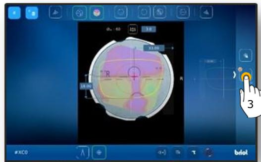
Figura 36 Centrado de una lente progresiva (3)
