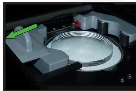
☰ Alinee la montura centrada con los dos agujeros de referencia (REF) en la herramienta de desplazamiento.
